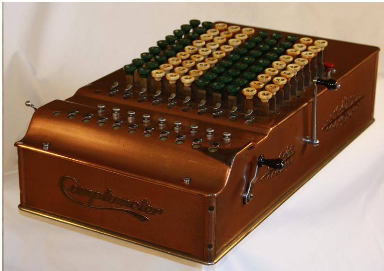
Figura 3.10: Máquina de cálculo diseñada por el Dorr E. Fer en 1884. Tuvo un gran éxito comercial debido a su facilidad de uso y su rapidez a la hora de realizar sumas y restas. Se fabricó sin interrupción desde 1886 hasta 1974. Se mantuvo en uso hasta la década de 1990, cuando se reemplazaron los últimos ejemplares por calculadoras electrónicas.
