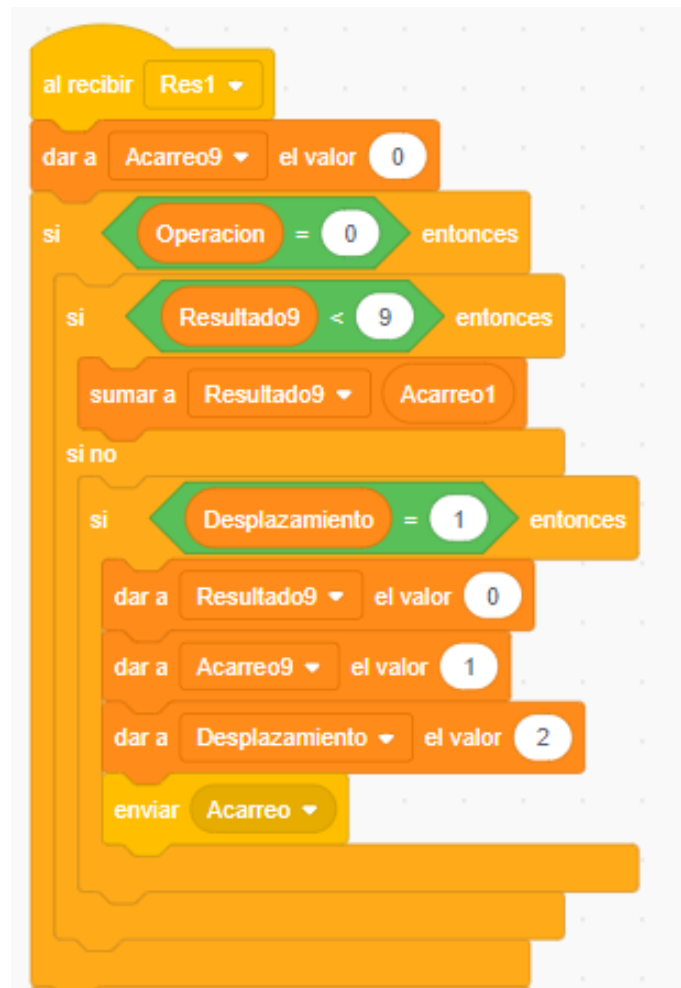
Figura 5.15: Código de cálculo de las centenas de millón para la suma. El código se ejecuta cuando se recibe el evento «Res1», que indica que el cálculo de la cifra anterior ya se ha realizado. En primer lugar, se da el valor 0 a la variable Acarreo9, para evitar colisiones con el cálculo anterior. Posteriormente, si operación es igual a 0 (lo que indica que se está realizando una suma), y el valor almacenado es menor que 9, se le suma al resultado el acarreo recibido, si no se envía el desplazamiento y se cambia el valor a 0.
