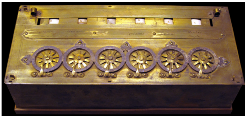
Figura 3.6: Réplica de la máquina de calcular inventada por el francés Blaise Pascal en 1642. La Pascalina, nombre que recibió el invento, tuvo una gran popularidad pese a ser capaz únicamente de realizar sumas de forma automática.
