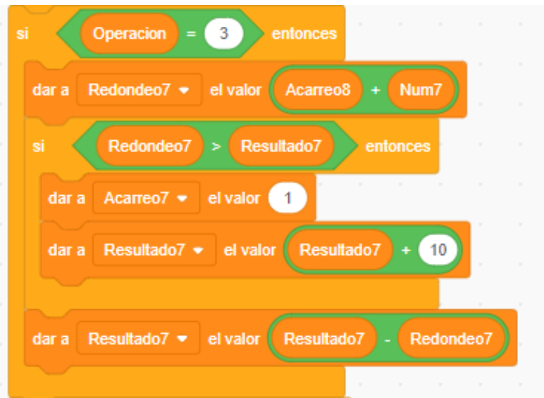
Figura 5.18: Código de cálculo de las centenas de millón para la resta. El código se ejecuta cuando se recibe el evento «Res8», que indica que el cálculo de la cifra anterior ya se ha realizado. Posteriormente, si operación es igual a 3 (lo que indica que se está realizando una resta), y el valor almacenado es mayor que la suma del acarreo más el valor introducido en los deslizadores, se le resta al resultado esta suma, en caso contrario, se suma 10 al resultado para que la resta no sea negativa. Se realiza la resta y se suma 1 al acarreo.
