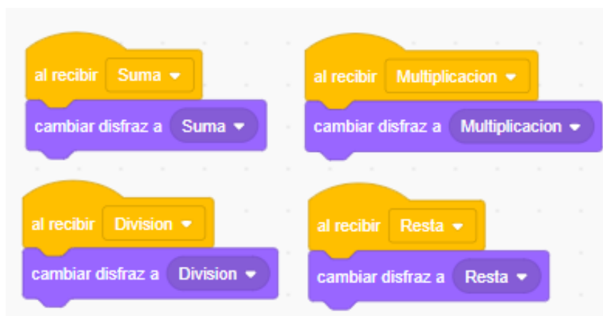
Figura 5.8: Código para cambiar el disfraz que indica con qué operación se está trabajando. Utiliza los eventos que genera la palanca de operación para saber el operador actual.
