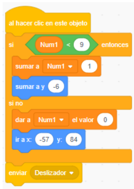
Figura 5.7: Código para mover los deslizadores, cada uno de los deslizadores cuenta con su propia variable que permite saber cuando tiene que volver al inicio. De esta forma, siempre que no se haya pinchado 9 veces sobre él, reduce el eje de ordenadas en 6 unidades. Sin embargo, cuando se pincha por novena vez vuelve a la posición inicial.
