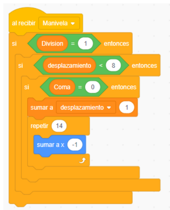
Figura 5.11: Código de la barra de cociente, las cifras y la palanca de reinicio cuando se realiza una división. Al girar la manivela se desplaza la barra de cociente para ir almacenando el valor en la posición adecuada. Este movimiento se realiza únicamente cuando se opera con una división, el número de desplazamientos acumulados no es superior a 7 y la variable coma es igual a 0.
