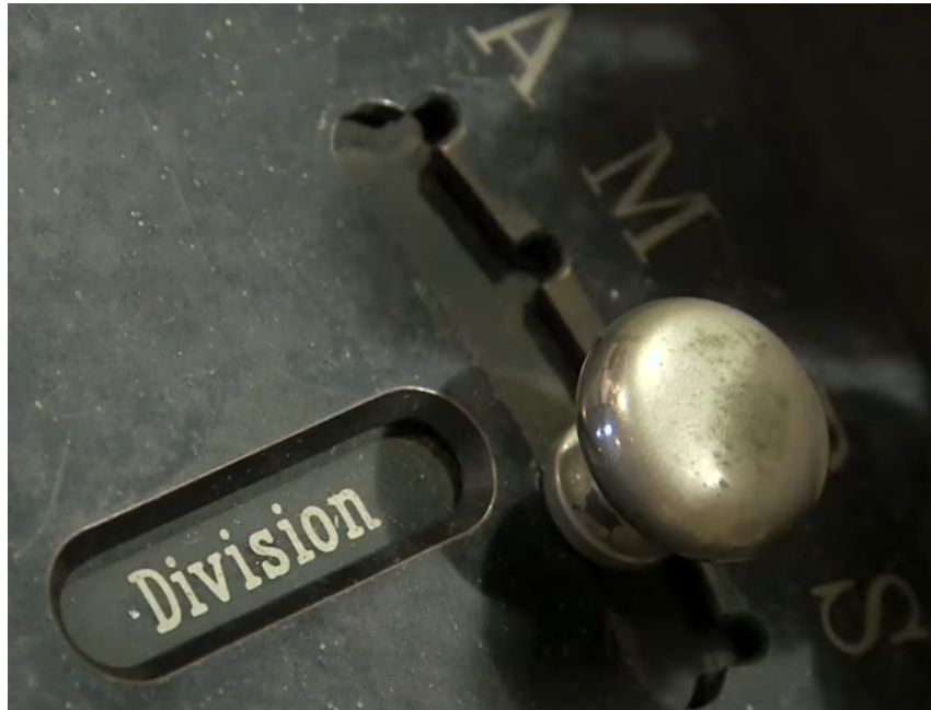
Figura 4.4: Palanca de la calculadora Millionaire utilizada para seleccionar el tipo de operación realizar. En la imagen se aprecia la ubicación de la palanca en la posición para efectuar la operación de división, y encima de la misma se pueden leer las letras A, M, D (casi tapada) y S.
