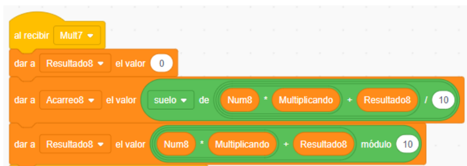
Figura 5.23: Código de cálculo del primer dígito del resultado en la multiplicación. Se calcula el acarreo a partir de la multiplicación del multiplicador con el dígito de las unidades del multiplicando. Posteriormente, se ajusta el acarreo del mismo modo que en la suma, con una aproximación a la baja, y se calcula el valor final de ese dígito.
