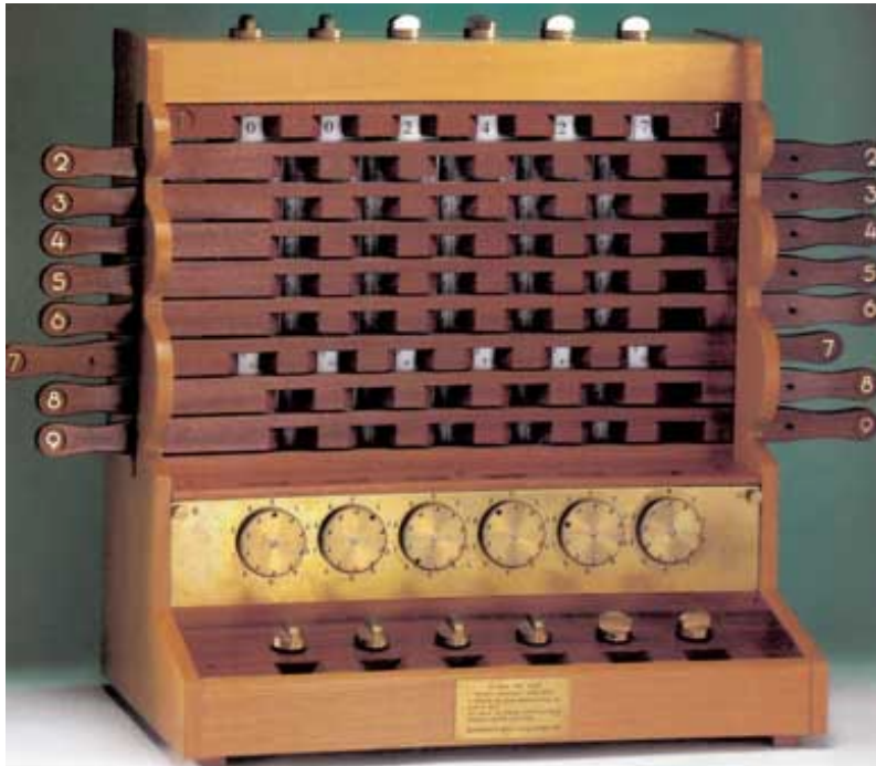
Figura 3.5: Réplica del reloj calculante inventado en 1623 por el astrónomo Wilhelm Schickard. Se trata de la primera máquina capaz de realizar operaciones aritméticas simples de forma autónoma.
