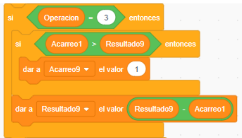
Figura 5.19: Código de cálculo de las centenas de millón para la resta. El código se ejecuta cuando se recibe el evento «Res1», que indica que el cálculo de la cifra anterior ya se ha realizado. Posteriormente, si operación es igual a 3 (lo que indica que se está realizando una resta), y el valor almacenado no es menor que el acarreo, se le resta al resultado este valor, en caso contrario. Se realiza la resta y se suma 1 al acarreo.
