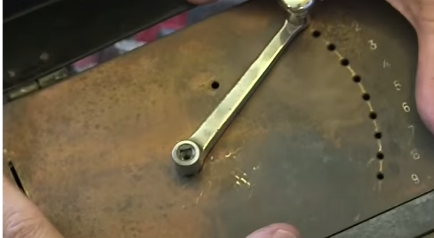
Figura 4.8: Palanca de la calculadora Millionaire utilizada en la multiplicación para definir por qué número se quiere multiplicar.
