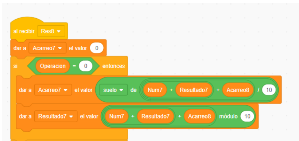
Figura 5.14: Código de cálculo de las decenas para la suma. El código se ejecuta cuando se recibe el evento «Res8», que indica que el cálculo de las unidades ya se ha realizado. En primer lugar, se da el valor 0 a la variable Acarreo7, para evitar colisiones con el cálculo anterior. Posteriormente, si operación es igual a 0 (lo que indica que se está realizando una suma), se calcula el acarreo a partir de la suma del número introducido, el valor almacenado del cálculo anterior y el acarreo arrastrado de la cifra inmediatamente menor. A esta operación se le aplica la función «Suelo» que redondea el número a la baja. Por último, se le da valor a la variable resultado, obteniendo el resto de la suma calculada para el acarreo, dividido entre 10.
