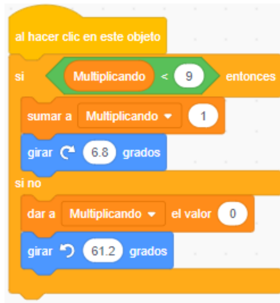
Figura 5.6: Código de movimiento de la palanca de multiplicación. Al clicar sobre ella, hace un movimiento de rotación de 6,8 grados siempre y cuando no se encuentre en la posición 9, donde deshacerá todo lo rotado. Utiliza una variable para determinar cuándo ha llegado a la última posición.
