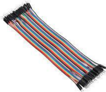
Figura 21: Cables puente macho-macho
