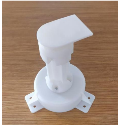
Figura 82: Montaje de la base, el soporte y la base del hombro
