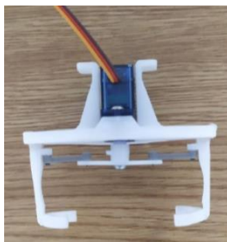
Figura 86: Montaje de la pinza
