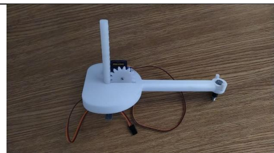
Figura 84: Montaje del eslabón 2, el eslabón 3, el engranaje y 2 servomotores SG90
