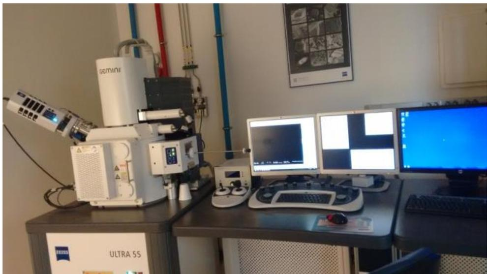
Figura 3.6. Microscopio electrónico de barrido de emisión de campo ZEISS ULTRA55.
