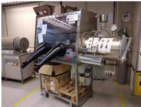
**FIGURA 18. BANCO DE GUANTES DEL LABORATORIO EMPLEADO PARA ALMACENAR LOS POLVOS METÁLICOS EN ATMÓSFERA CONTROLADA.**
