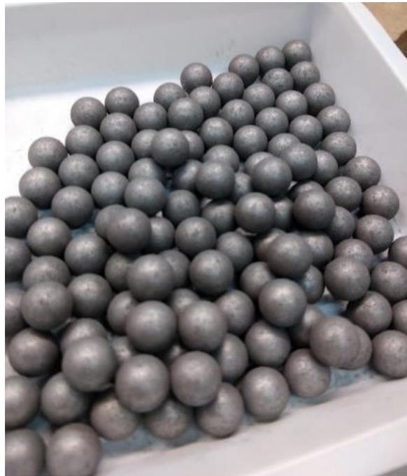
**FIGURA 20. BOLAS DE ACERO EMPLEADAS EN EL ALEADO MECÁNICO.**
