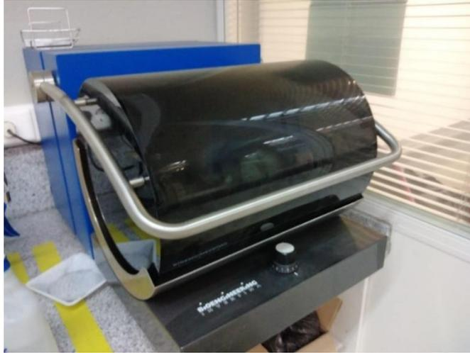
**FIGURA 19. TÚBULA EMPLEADA EN HOMOGENIZACIÓN DE POLVOS.**
