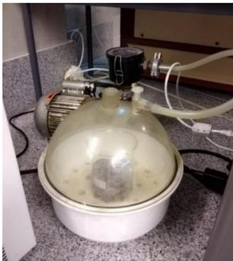
**FIGURA 26. BOMBA DE VACÍO.**
