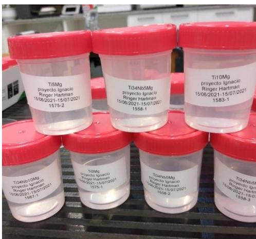
**FIGURA 35. RECIPIENTES CON SALIVA UTILIZADOS EN EL ENSAYO DE LIBERACIÓN DE IONES.**
