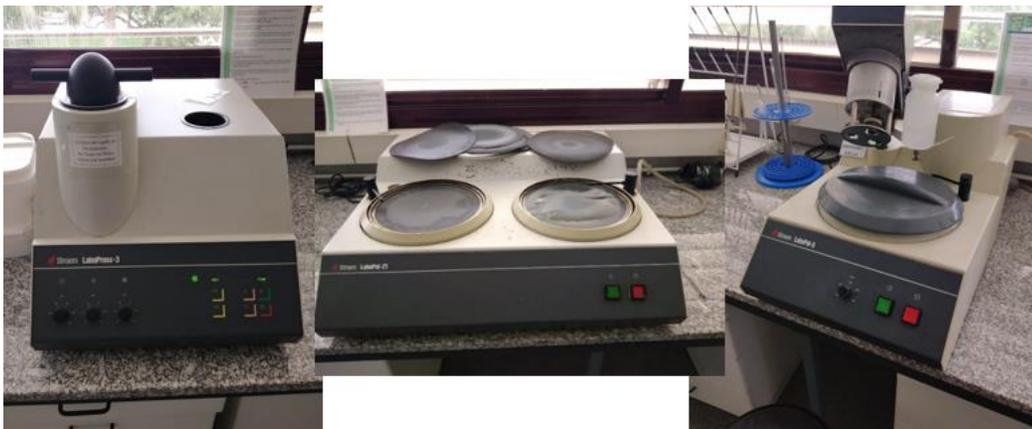
**FIGURA 32. A LA IZQUIERDA LA EMBUTIDORA, EN EL CENTRO LA DESBASTADORA CON LOS PAÑOS DE DIFERENTES TAMAÑOS DE GRANO Y A LA DERECHA LA PULIDORA.**
