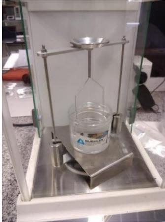
**FIGURA 25. MONTAJE DEL ENSAYO DE ARQUÍMEDES.**
