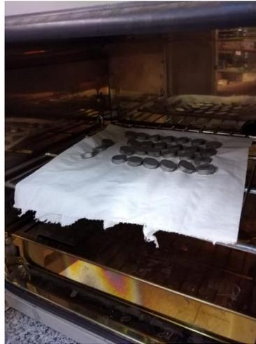
**FIGURA 27. ESTUFA CON MUESTRAS DE BE TRAS EL ENSAYO DE ARQUÍMEDES LISTAS PARA SU DESECACIÓN.**
