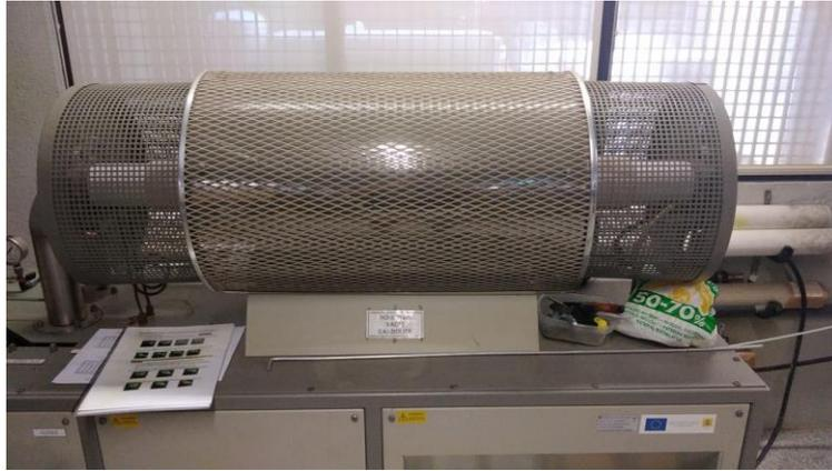
**FIGURA 24. HORNO DE SINTERIZACIÓN.**
