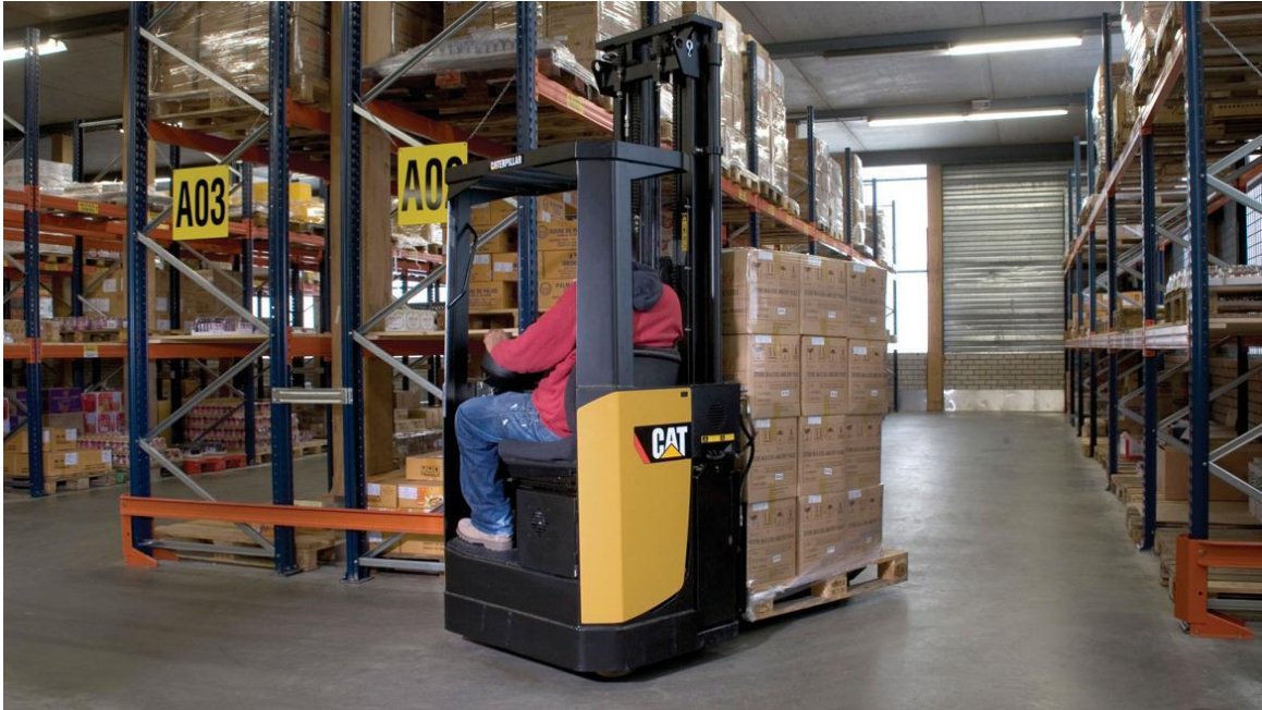
Figura 7: Apiladora eléctrica con conductor sentado
