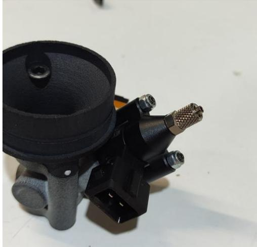
*Figura 32: Tapa del inyector mecanizada en aluminio*
