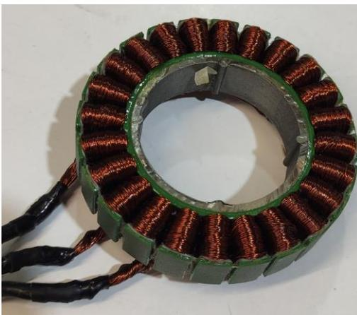
*Figura 3: Estator/bobinado*
