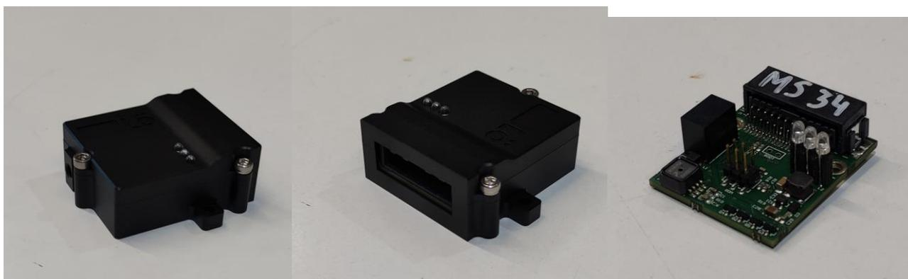
*Figura 40: ECU con y sin su correspondiente carcasa*
