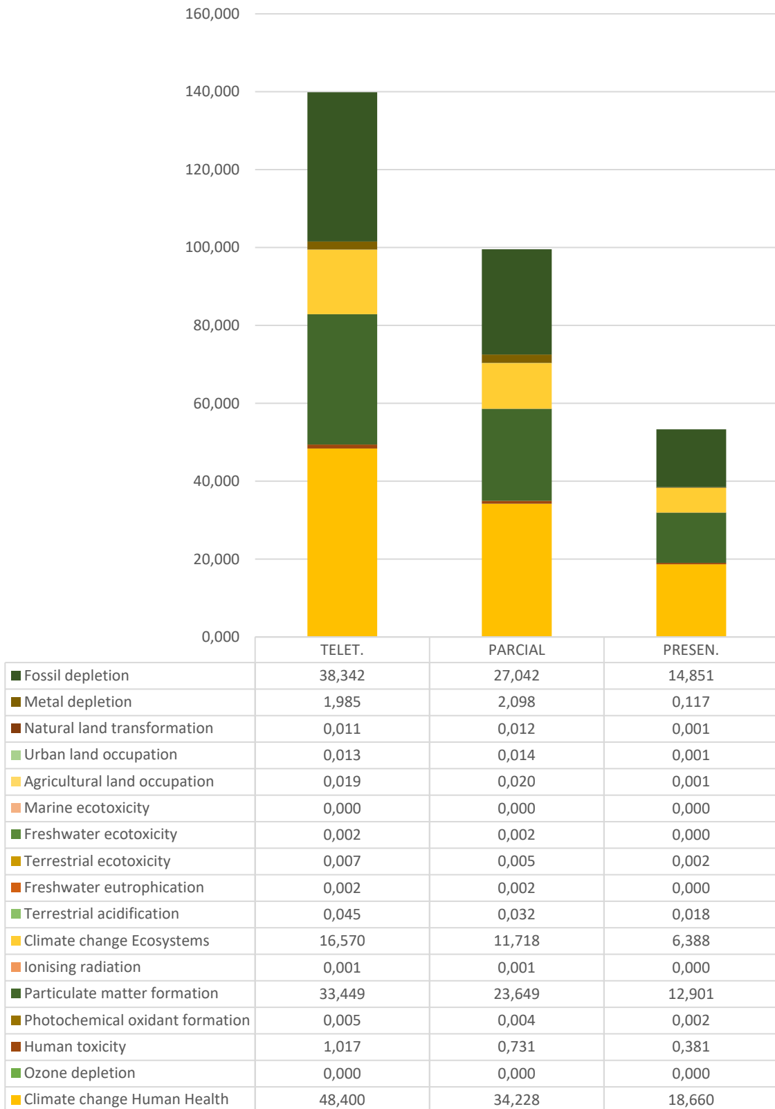
Figura 53. Gráfica de puntuación única por categoría de impacto, en acondicionamiento térmico, por situación laboral. (Elaboración propia, 2021)
