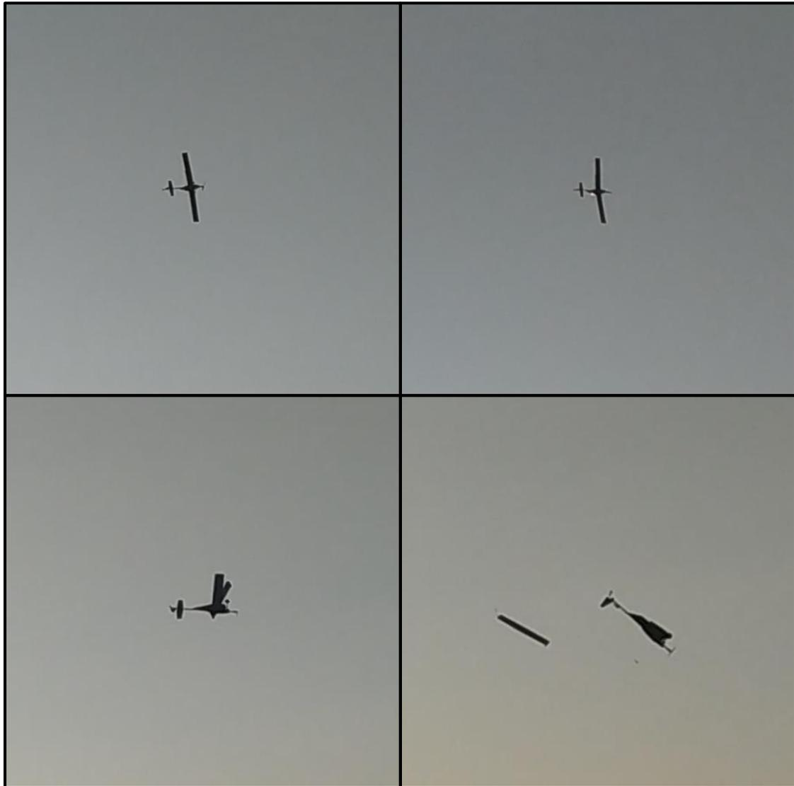
Figura 8.18. Colapso estructural del demostrador en su vuelo n° 10
