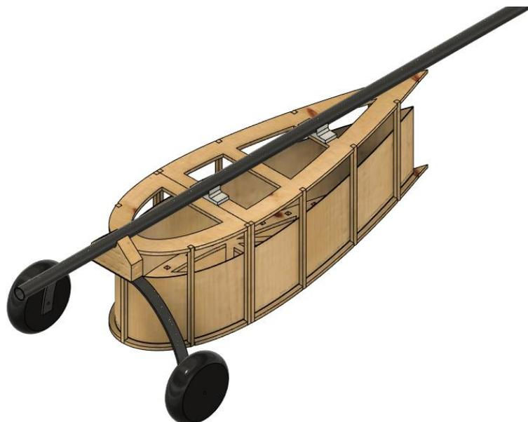
*Figura 7.7. Estructura y ensamblaje de la bahía y el tren de aterrizaje del demostrador*
