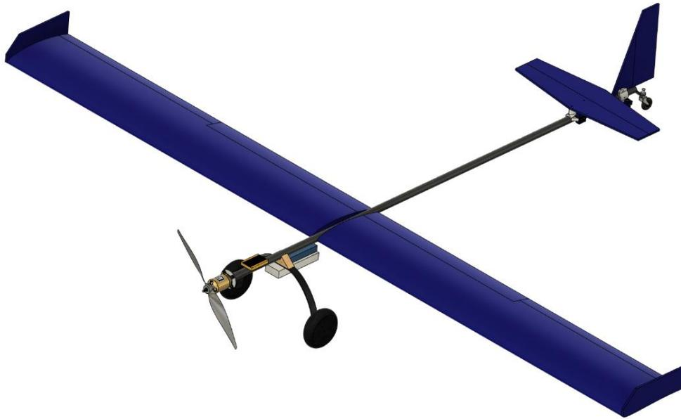
*Figura 8.1. Modelo CAD del Xtra23 Demostrador sin bahía de carga*
