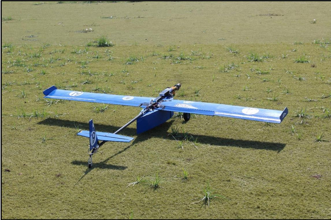
*Figura 8.5. Modelo demostrador del Xtra23 con bahía de carga en su PDV 3*
