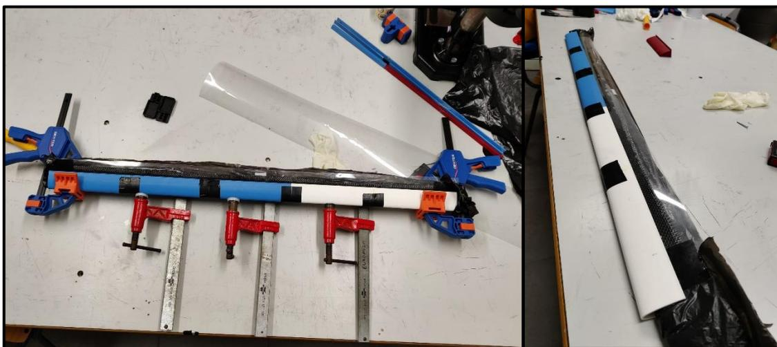
Figura 7.14. Ensayo para la fabricación del borde de ataque con material compuesto
