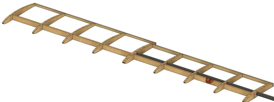
*Figura 7.13. Estructura interna del ala, formada por largueros y costillas*
