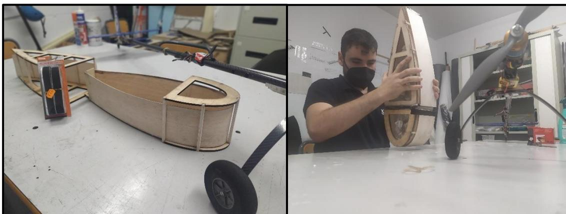
*Figura 7.8. Fabricación y validación del sistema de cierre de la bahía del demostrador*
