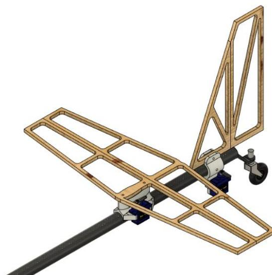
*Figura 7.9. Ensamblaje del empenaje*
