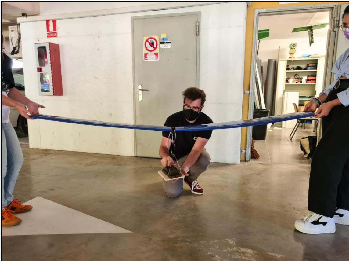
*Figura 7.18. Ensayo de resistencia a flexión estática con 3.2 kg de carga*
