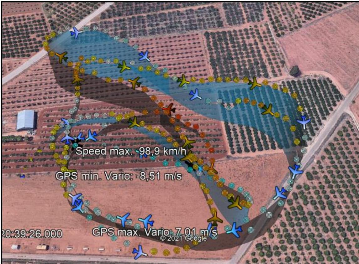
Figura 8.10. Trayectoria del vuelo 3 según el sistema de medición del UAV
