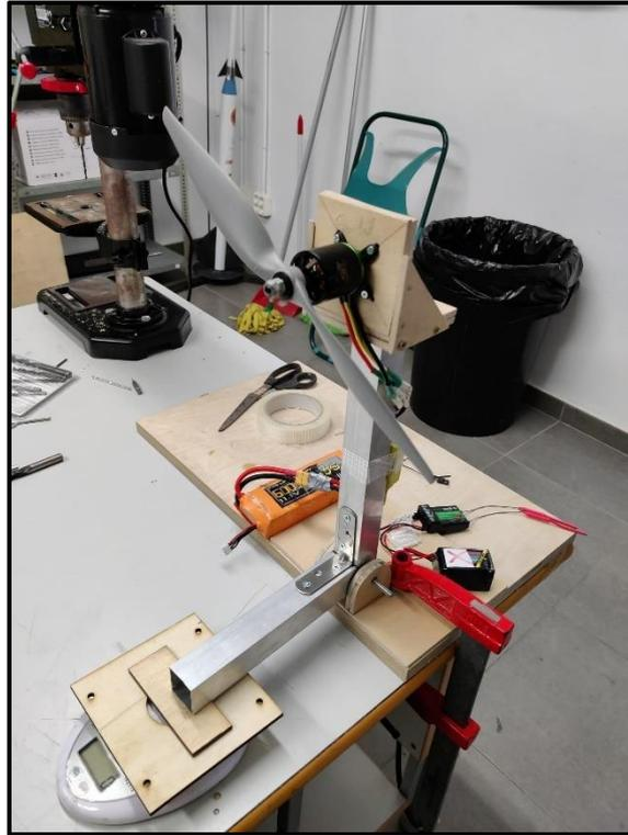
Figura 4.5. Banco de ensayos construido para hallar el empuje estático
