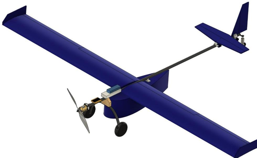
*Figura 8.2. Modelo CAD del Xtra23 Demostrador con bahía de carga*
