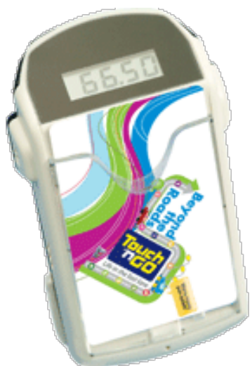
Figura 43: Sistema de pago electrónico SmartTAG para el pago de peajes en autopistas.
