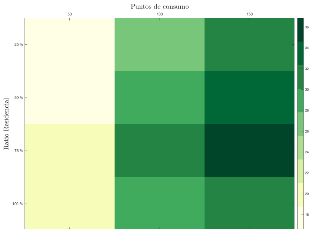
Figura 38. Emisiones evitadas en promedio durante el ciclo de vida de la CEL para escenarios del Caso 1 (tCO 2 eq).
