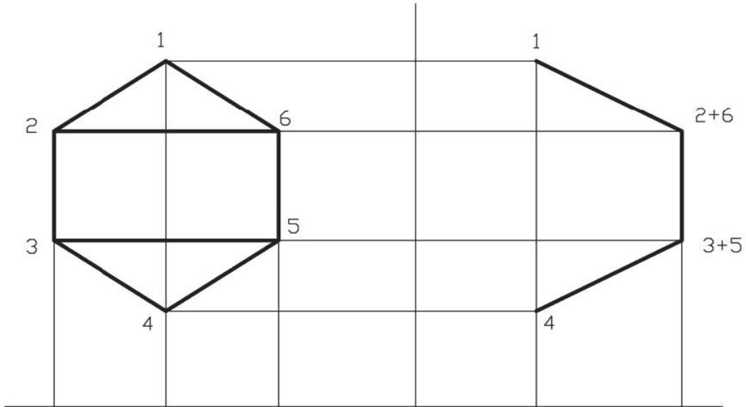
7.- Sistema Diédrico. Dados el alzado y la planta en el sistema europeo, dibujar la vista lateral izquierda y acotar según las normas UNE.
