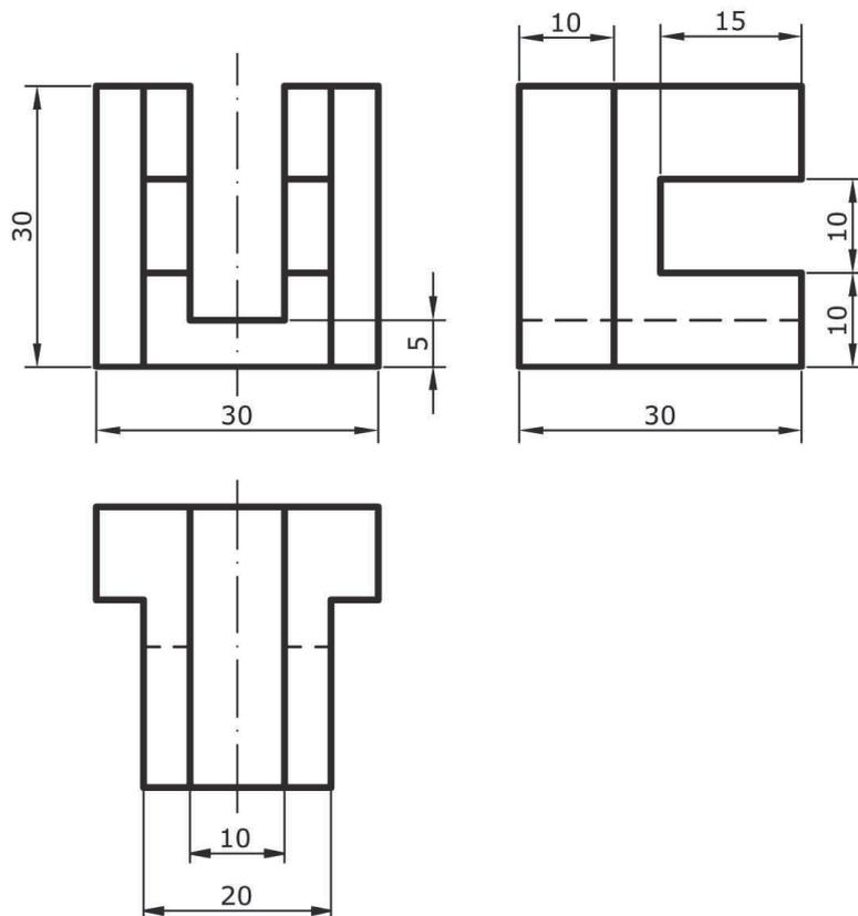
4.- Dibujar a escala 3:2 el alzado, la planta y la vista lateral izquierda del objeto dado por su representación isométrica. El alzado es el que se indica. Tomar las medidas directamente de la figura. Realizar la acotación completa de las mismas según la norma UNE.
