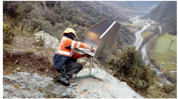
Figura 6: Instalación y orientación de un reflector pasivo en la ladera en movimiento de La Portalada (Andorra, diciembre de 2020).
