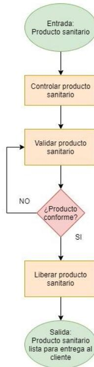
Figure 15. Diagrama de flujo de proceso controlar, validar y liberar producto.
