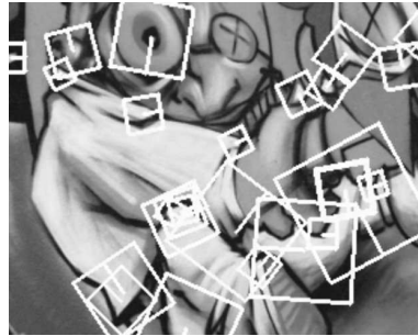
Figura 2.40: Puntos de interés extraídos y sus orientaciones.
