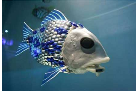
Figura 2.6: Robot nadador con forma de pez.
