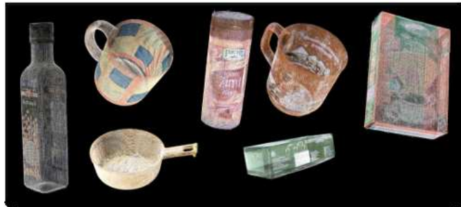
Figura 2.35: Varias estructuras 3D formadas a partir de nubes de puntos.
