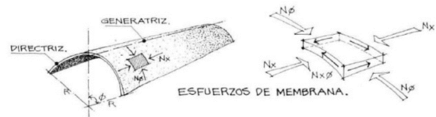
Figura 2.21 Esfuerzos en membrana
