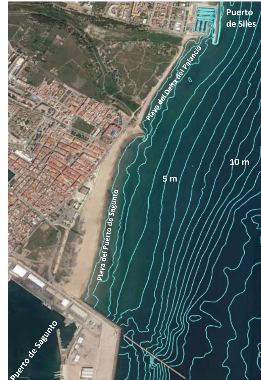
Figura 68. Batimetría entre el Puerto de Siles y el Puerto de Sagunto (Fuente: MITECO)
