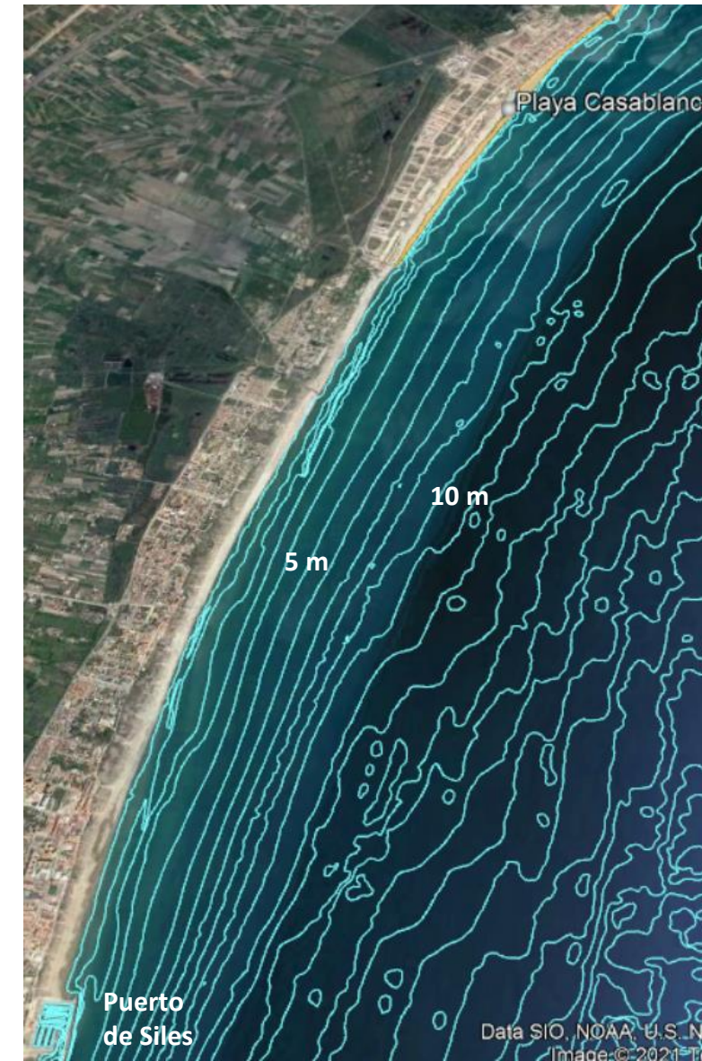
Figura 66. Batimetría entre la Gola de Queralt y el Puerto de Siles (Fuente: MITECO)
