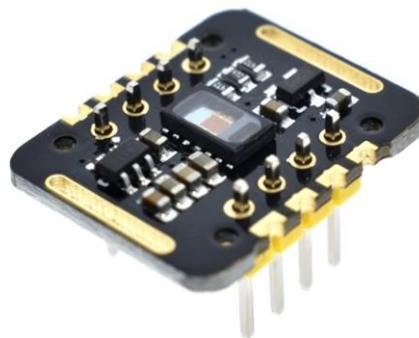
Ilustración 3.3 - Sensor "Max30102" para la medición de la frecuencia cardiaca de la empresa Maxim Integrated
