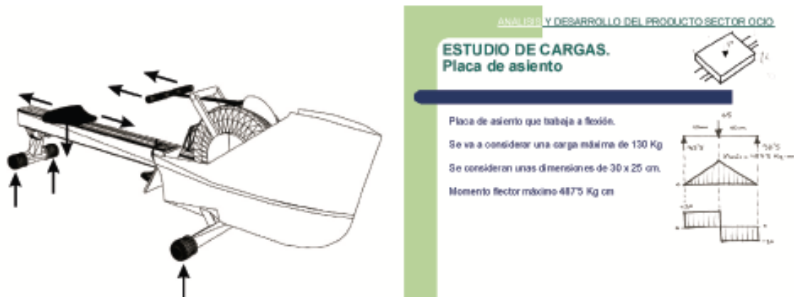
Figura 3. Modelización de las cargas que actúan sobre el producto.
