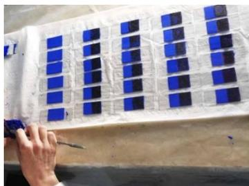
Figura 29. Pruebas de limpieza sobre probetas.
