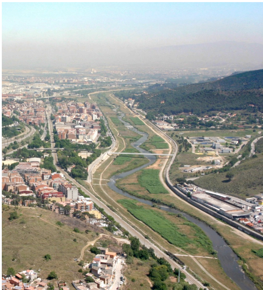
Figura 10. Parque fluvial del río Besòs. Restauración con criterios morfológicos del tramo de aguas arriba. Se observa la presencia de humedales artificiales en el lecho del cauce de avenidas (entre el cauce principal sinuoso y las márgenes del encauzamiento) como elementos de fito-depuración final de los efluentes de la depuradora situada junto al cauce (centro-derecha en la imagen). Fuente: Martín Vide, 2015.
