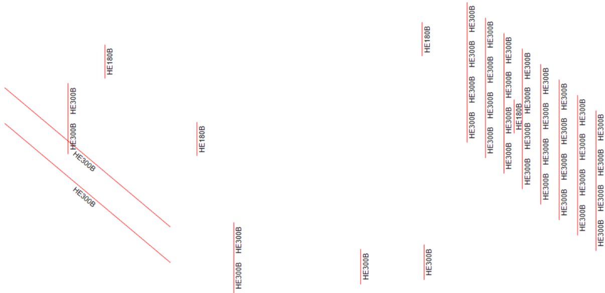
Figura 70. Barras de la estructura metálica que no cumplen a resistencia. [Extraído de SAP 2000]
