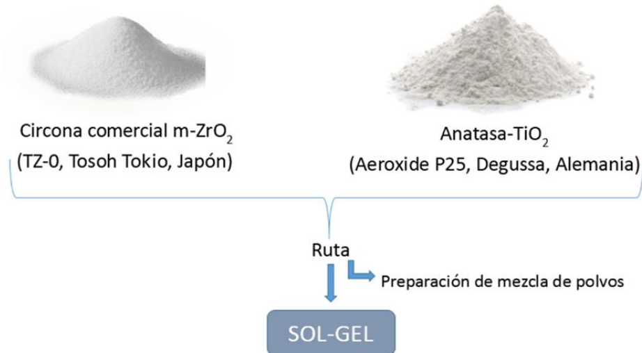
Figura 5. 1. Polvos de partida del material.
