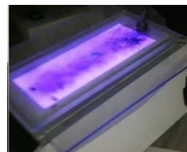
Figura 6. 27. Activación por plasma.
