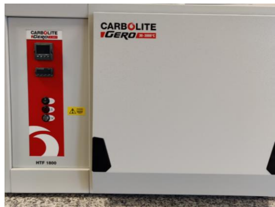
Figura 3. 14. Horno eléctrico (Carbolite Gero, HTF 1800). ITM-UPV.
