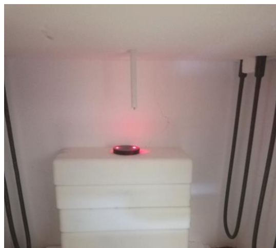
Figura 3. 20. Montaje de muestra en horno con verificación de posición mediante laser de pirómetro.
