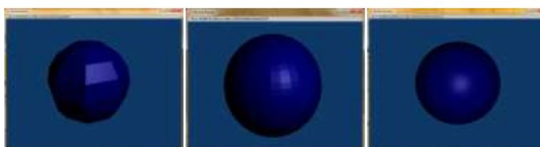
*Figura 4-5. Muestra de algunas esferas utilizadas con diferente número de caras: 112, 8.604 y 130.560.*
