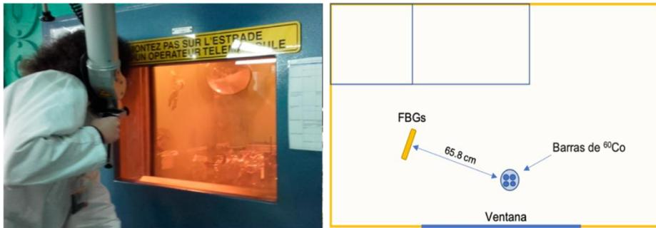
Figura 5.5. Foto de la cámara de irradiación IRMA (izquierda) [17]. Plano de la posición de la fuente radioactiva y el soporte los sensores dentro de la cámara (derecha).
