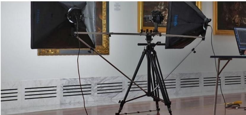
**Figura 10.** Soporte específico para fijar el sistema de iluminación al trípode.
