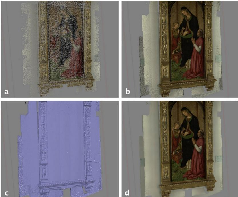
**Figura 30.** (a) Nube de puntos. (b) Nube densa. (c) Malla poligonal. (d) Modelo texturizado
