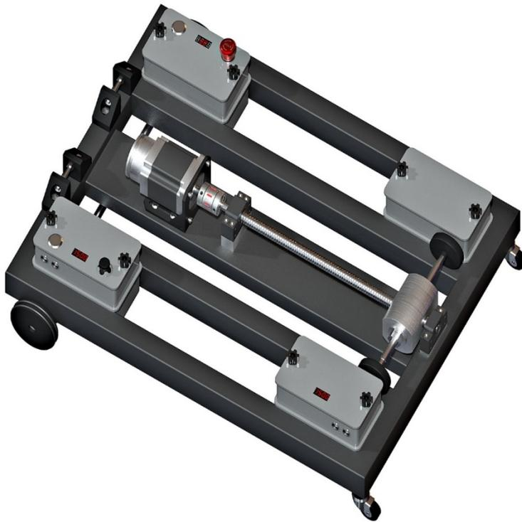
**Figura 99.** Modelización fotorrealista en perspectiva militar del bastidor inferior de la plataforma sobre el que se monta el mecanismo de la tijera
