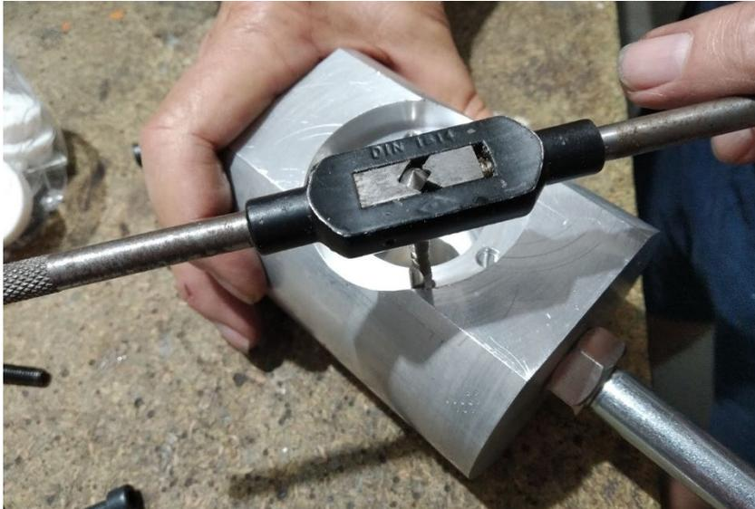
**Figura 104.**Proceso de fabricación del brazo de arrastre que acciona la tijera
