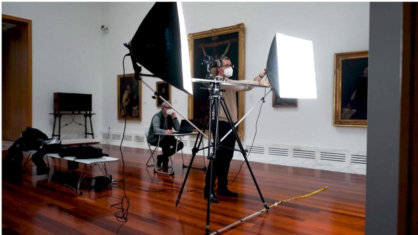
Figura 13. Ajuste del sistema de iluminación para evitar reflejos en el lienzo
