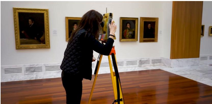
**Figura 23.** Sistema de medición topográfico de las obras mediante la estación total
