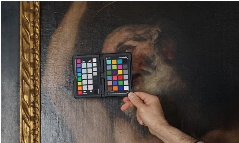
**Figura 11.** Imagen de referencia con la tabla X-Rite ColorChecker para el ajuste del balance de blancos y para crear un perfil de color específico de la escena
