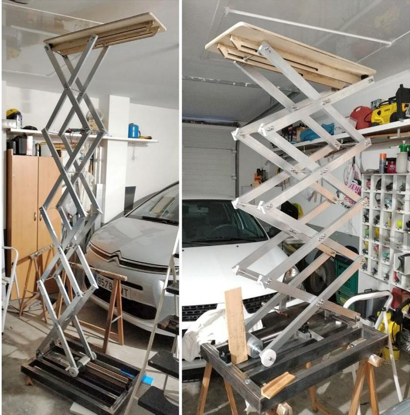
**Figura 107.** Pruebas del funcionamiento del mecanismo de la tijera a distintas alturas durante el proceso de fabricación
