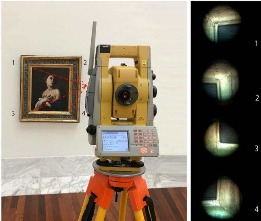
**Figura 24.** Identificación y medición con estación total GPT-9000 IS de puntos de control
