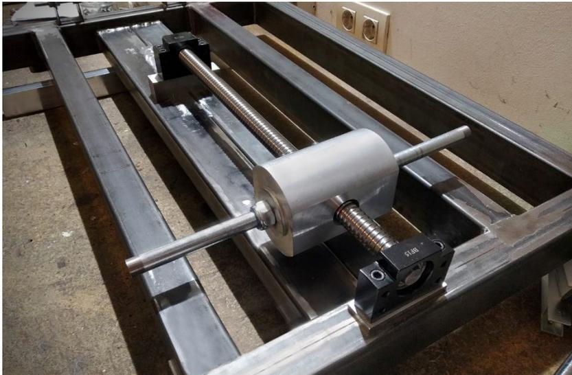
**Figura 106.** Brazo de arrastre y husillo unido al chasis mediante los soportes especiales BK 15 y BF 15
