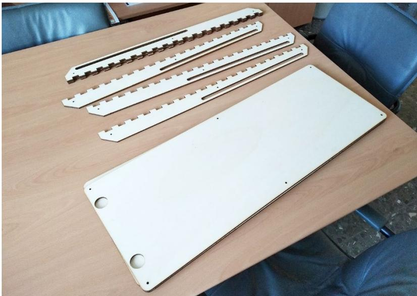
**Figura 103.** Madera contrachapada cortada con láser para configurar la bandeja que sustenta el equipo fotográfico
