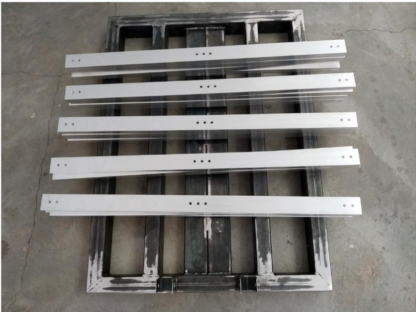
**Figura 101.** Corte y mecanizado de los brazos de la tijera, constituidos por perfiles de aluminio con sección rectangular de 40x20 mm con un espesor de pared de 2 mm
