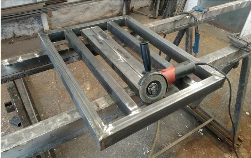
**Figura 100.** Construcción del chasis de la plataforma, constituido por perfiles tubulares de acero de 60x40 mm
