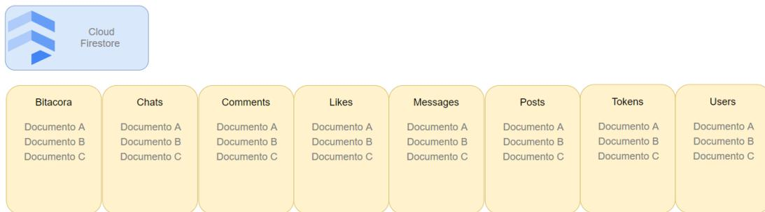
Figura 14 Diseño de la base de datos Cloud Firestore
