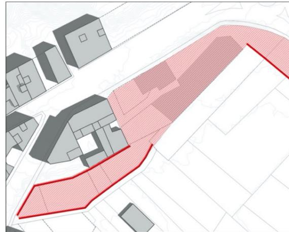
Mediante el sistema de muros de bancales existente se busca unificar el terreno para unificar la superficie a la misma cota e introducirla en el paisaje acabándola con un muro de sillería.
