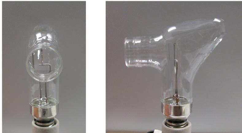
**Figura 4.23:** Lámpara de calibración. A la izquierda corresponde a la parte frontal de la lámpara. Y a la derecha corresponde a la parte lateral de la lámpara (adaptada de García [17]).
