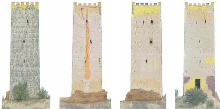
Figura 9. Mapa de daños presentado previo a la restauración del 2019.
