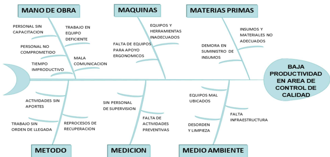
Imagen 8. Diagrama de cola de pescado, causa-efecto de baja productividad de la empresa.
