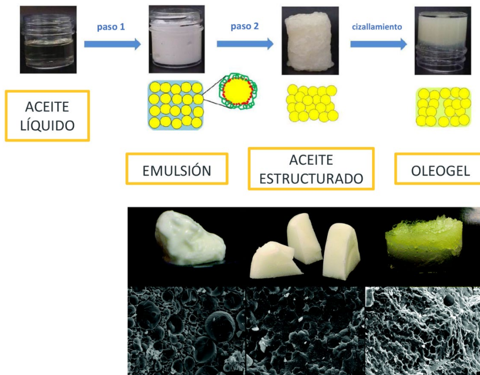
Figura 3. Representación esquemática del proceso general de oleogelificación con imágenes "macroscópicas" y micrografías cryo-SEM (escala = 10 \mu m) (adaptado Patel et al., (2014, 2015)).
