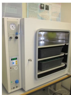
Equipo de impregnación. Bandejas y panel de control.
