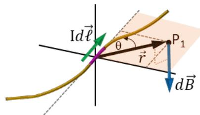
Figura 1. Campo magnético  $d\vec{B}$  generado en un punto  $P_1$  por un elemento de corriente  $Id\vec{\ell}$  (Fuente: Tipler Mosca, 5ª Edición, Volumen 2).
