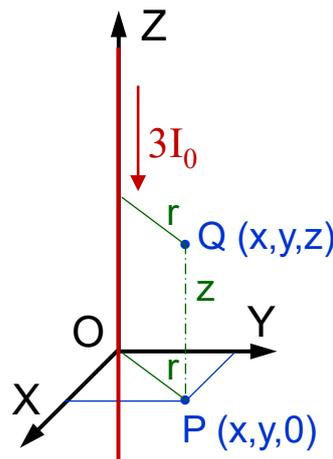
Figura 3. Ejemplo de aplicación. Intensidad de corriente y sistema de referencia adoptado para la resolución del caso. Los puntos P y Q están a la misma distancia  $r$  del conductor.
