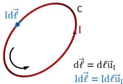
Figura 2. Circuito  $C$ , intensidad  $I$  y elemento de corriente  $Id\vec{\ell}$ .
