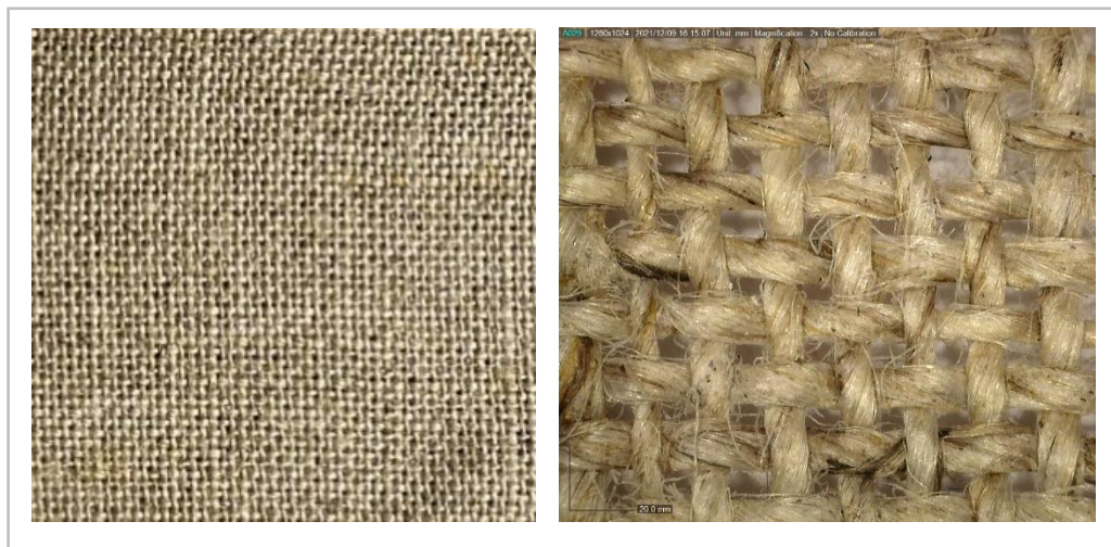
Figura 57. Fotografía del tejido de lino. Izquierda, realizada con cámara DMC-FZ38, (1/10s, f/8, 4,8mm) y derecha, obtenida mediante el microscopio digital Dino-Lite 20x.
