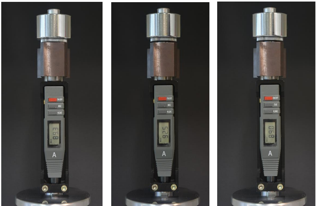
Figura 70. Ensayos de dureza Shore A con el Dinamómetro PCE FM-200.
