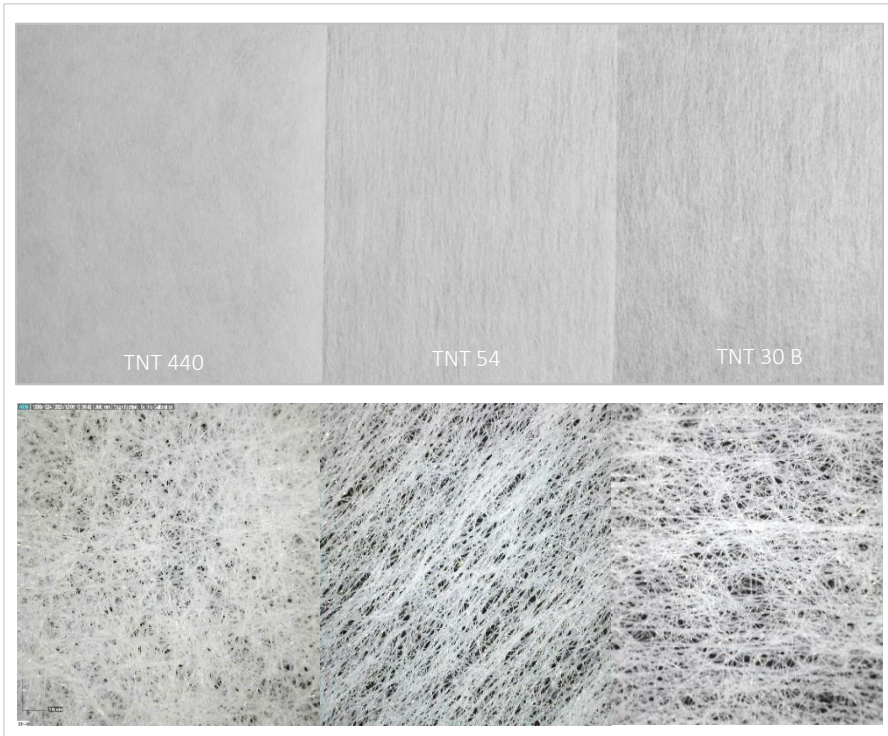
Figura 61. Fotografías generales de los estratos intermedios de tipo sintético empleados en la investigación (superior) realizadas con cámara DMC-FZ38, (1/15s, f/5,6 4,6mm. Fotografías inferiores, entrecruzado de las fibras de cada uno de los TNT, obtenidas mediante el microscopio digital Dino-Lite a 20x.
