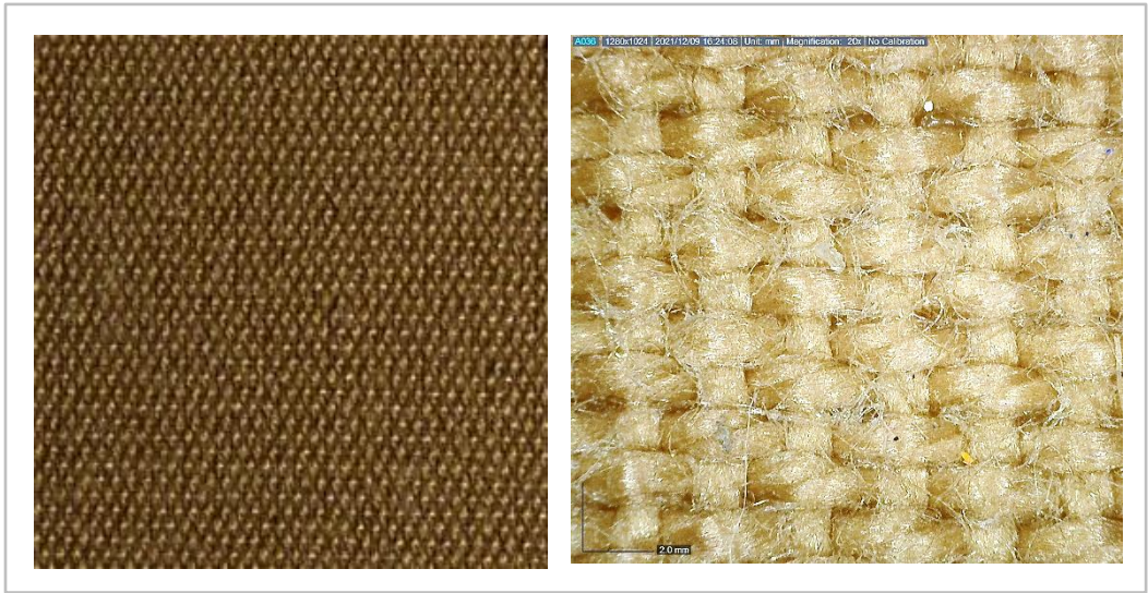
Figura 60. Tejido sintético Sintel®. Izquierda, fotografía realizada con cámara DMC-FZ38, (1/10s, f/8, 4,8mm), y derecha, macrofotografía realizada mediante el microscopio digital Dino-Lite a 20x.
