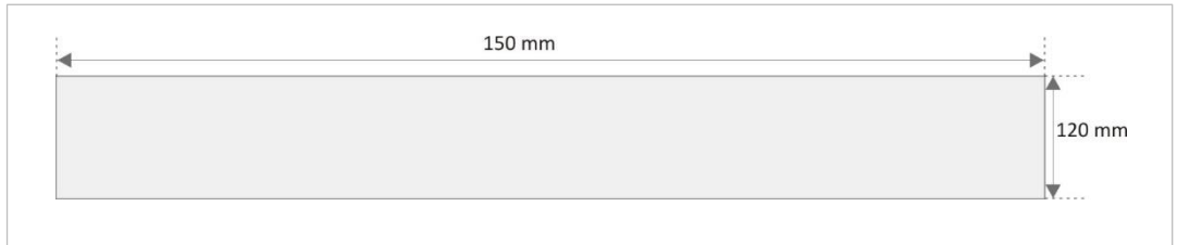
Figura 68. Formato y croquis de medidas de las probetas del ensayo de pelado en T.
