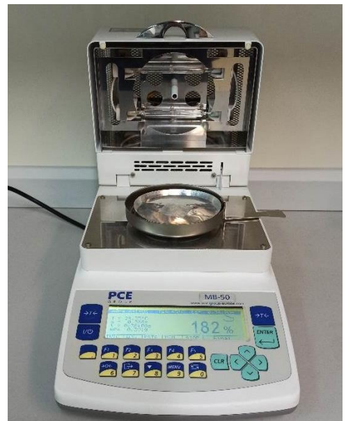
Figura 62. Proceso de análisis experimental termogravimétrico de los films adhesivos.
