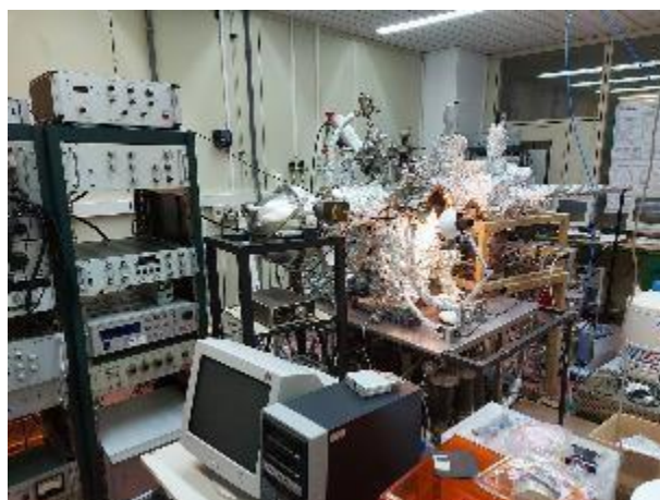
Figura 24: Instalación de XPS
