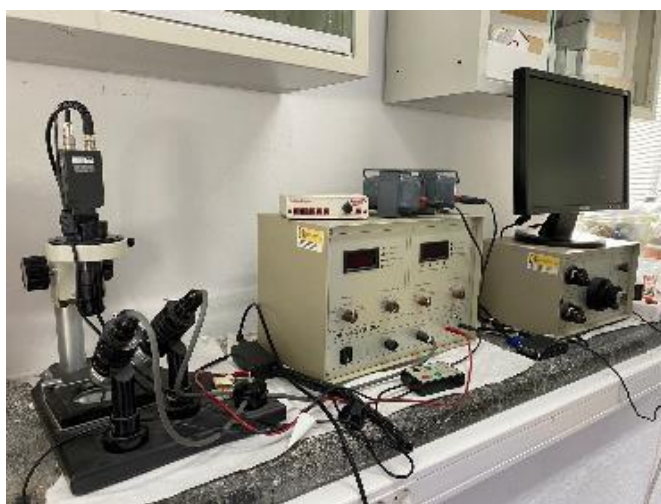
Figura 29: Zeta Meter 3.0, celda micro-electroforética y electrodos utilizados en las medidas de potencial zeta (217).
