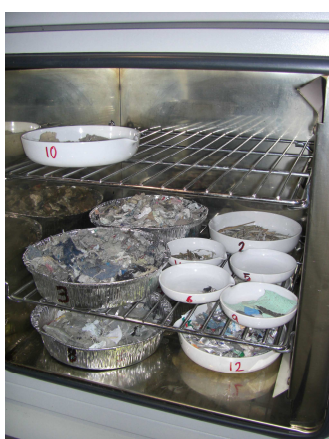
Figura 3.2 Secado en estufa de las diferentes fracciones para conocer su contenido en humedad
