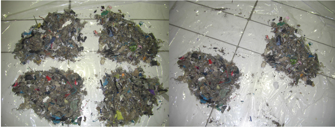
Figura 3.12 Muestreo por cuarteo llevado a cabo en el laboratorio
