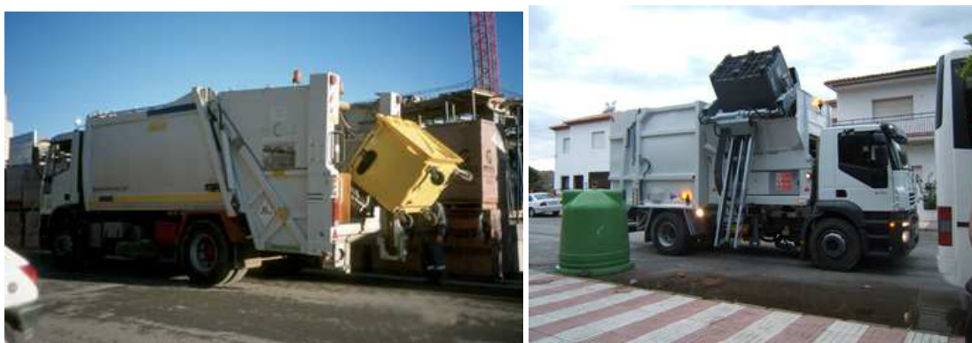
Figura 1.6 Camión compactador de carga mecánica trasera y de carga mecánica lateral.
