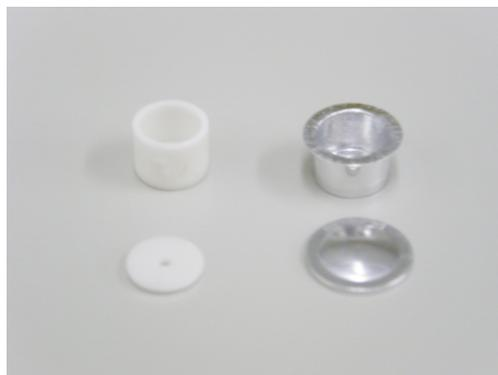
**Figura 43 Crisol de alúmina con orificio (izda.) y crisol de aluminio de tapa perforada (dcha.).**
