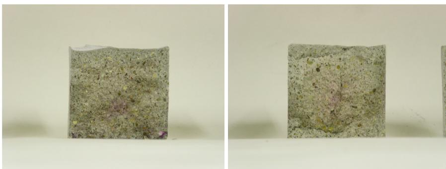
**Figura 105. Fotografías de morteros tras la el proceso de carbonatación. Relación a/mc de 0,7. Izquierda: 0% FCC; derecha: 15% FCC.**
