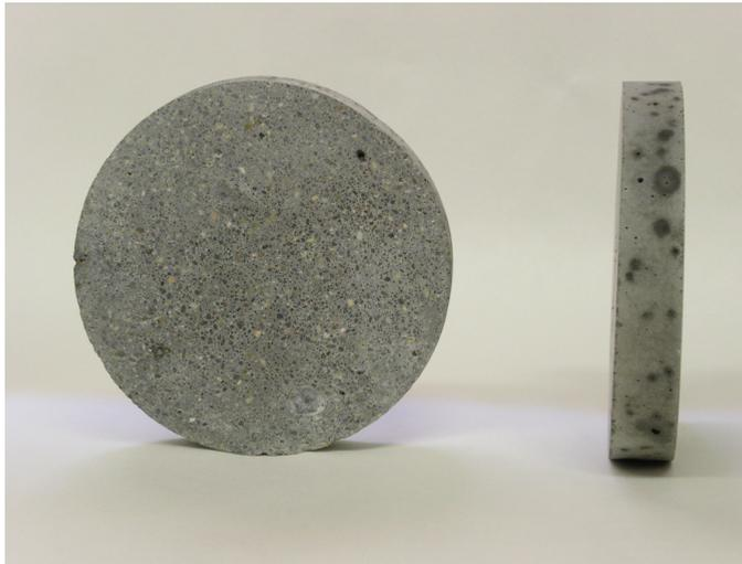
**Figura 142. Fotografía de los discos de mortero empleados en los ensayos de migración de cloruros.**
