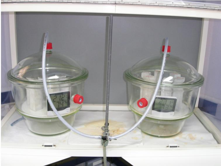
**Figura 41. Cámaras de carbonatación acelerada.**
