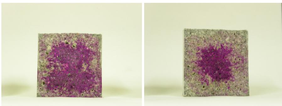
**Figura 104. Fotografías de morteros tras la el proceso de carbonatación. Relación a/mc de 0,5. Izquierda: 0% FCC; derecha: 15% FCC.**
