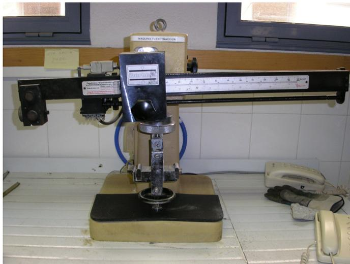
**Figura 94. Máquina de ensayos de resistencia a flexotracción para morteros.**
