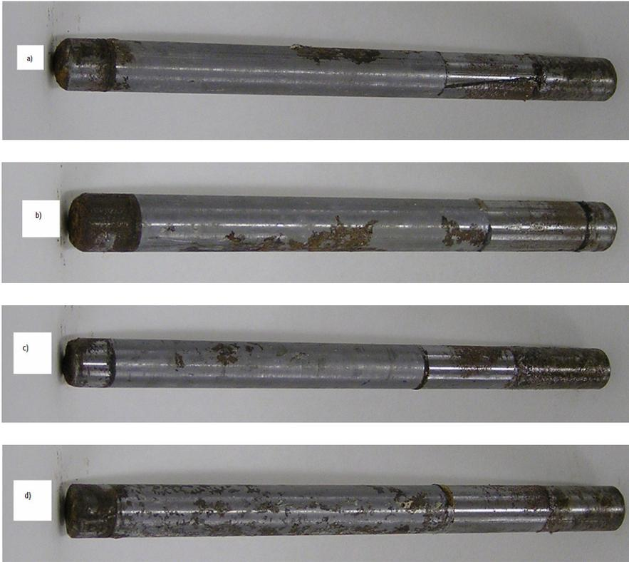
**Figura 164. Fotografías de los aceros empleados en el estudio tras la finalización de los ensayos. a) 0% FCC, 0% Cl<sup>-</sup>; b) 0% FCC, 2% Cl<sup>-</sup>; c) 15% FCC, 0% Cl<sup>-</sup>; d) 15% FCC, 2% Cl<sup>-</sup>.**
