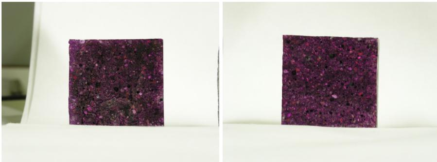
**Figura 102. Fotografías de morteros tras la el proceso de carbonatación. Relación a/mc de 0,3 con plastificante. Izquierda: 0% FCC; derecha: 15% FCC.**
