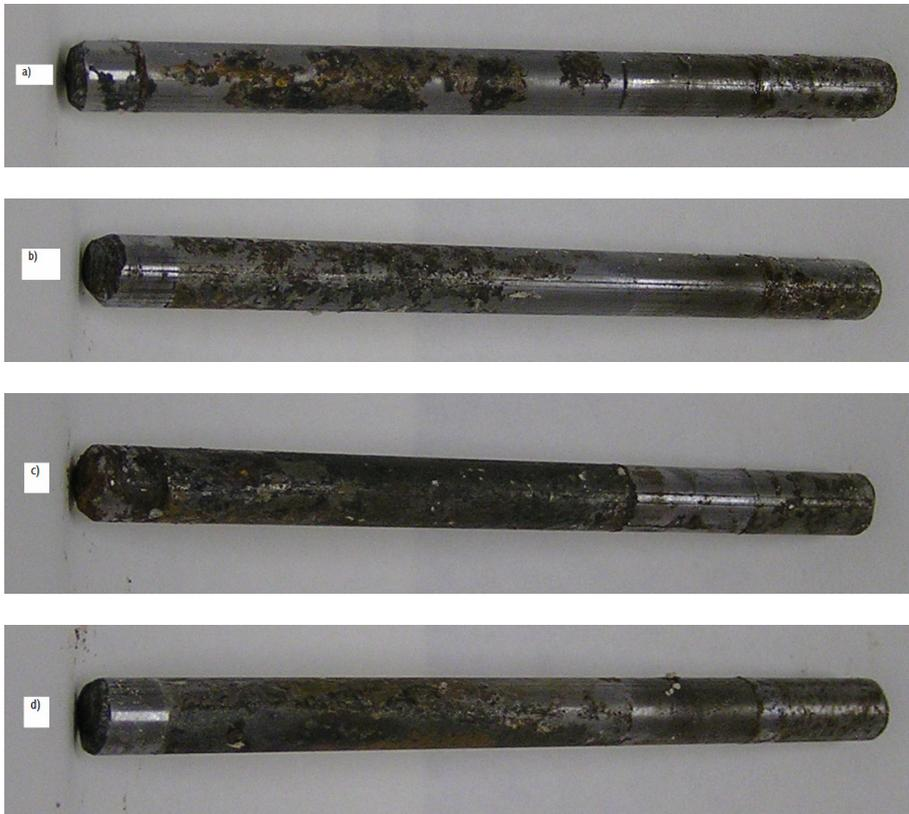
**Figura 160. Fotos de los electrodos tras las experiencias. a) 0% FCC, relación a/mc 0,5; b) 15% FCC, relación a/mc 0,5; c) 0% FCC, relación a/mc 0,7; d) 15% FCC, relación a/mc 0,7.**
