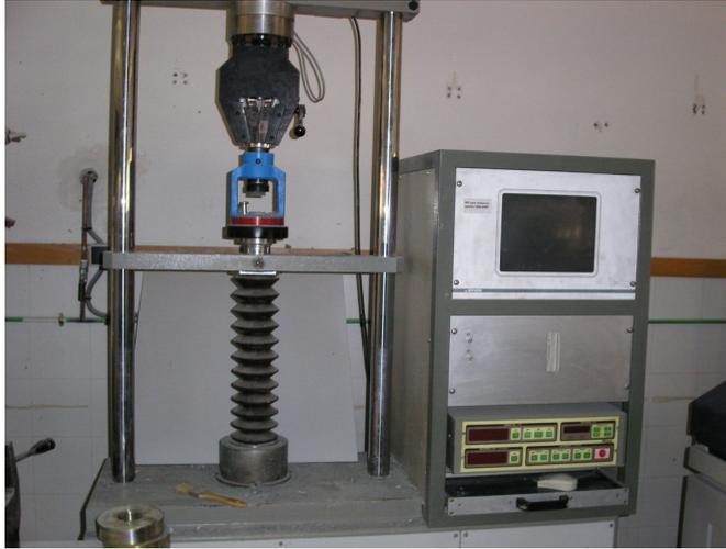
**Figura 95. Máquina multiensayos para realización de ensayos de resistencia a compresión en morteros.**
