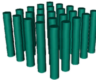
Fig. 12. Cristal bidimensional formado por cilindros dispuestos periódicamente sobre red cuadrada.
