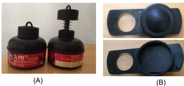
Figura 4.3. Cámaras de radón del sistema E-PERM. (A) Cámara tipo S; (B) cámaras tipo L-OO en posición cerrada.
