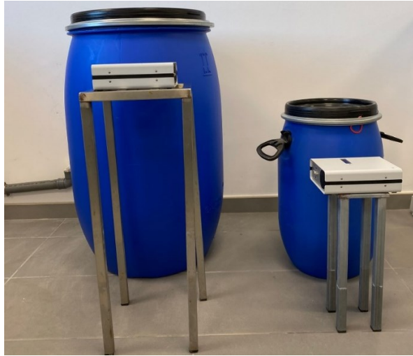
Figura 6.2. Imagen de los dos bidones con sus respectivos soportes metálicos y el detector Radon Scout Plus.
