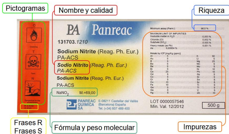
Figura 1.3: ejemplo de la etiqueta de un reactivo sólido de la casa comercial Panreac. Imagen extraída de la 'Guía de Operaciones Básicas en Análisis Químico, Farmacéutico y Medioambiental' de la Universidad de Valencia ( www.uv.es/gammmm/ )
