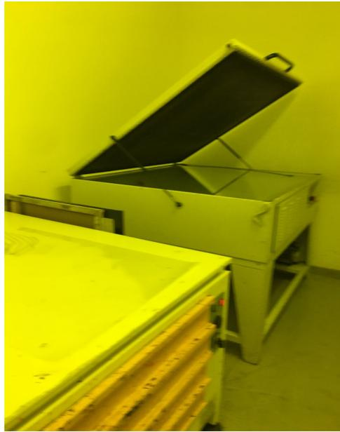
**Fig.127.**Se insolan los fotolitos de las imágenes trabajadas previamente con el Photoshop.
