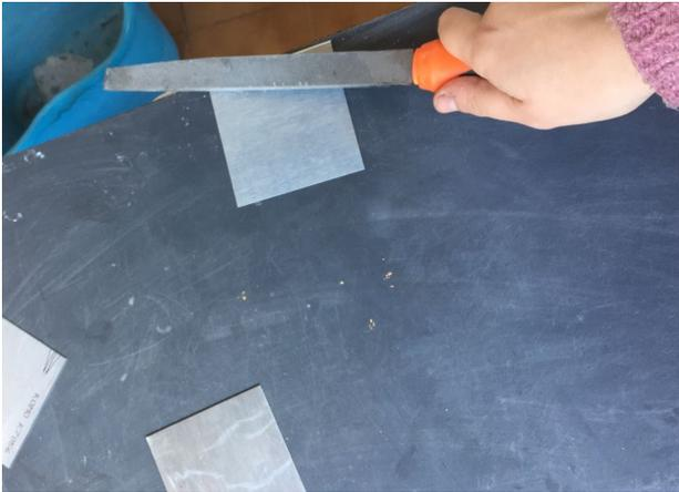
**Fig. 145.**Una vez cortamos las planchas de zinc, las biselamos y lijamos.
