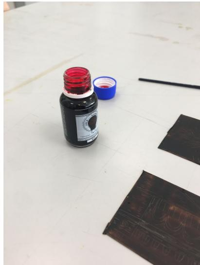
**Fig. 148.** Para asegurarnos que el ácido no muerda aquello que no deseamos, podemos darle alguna pincelada con laca de bombillas para proteger las capas menos densas.
