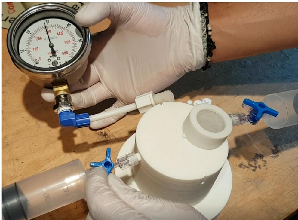
*Figura 2: Prueba de estanqueidad del sistema de cierre neumático.*
