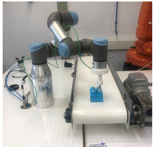
Figura 7.6: MoveL acercándose a coger la pieza
