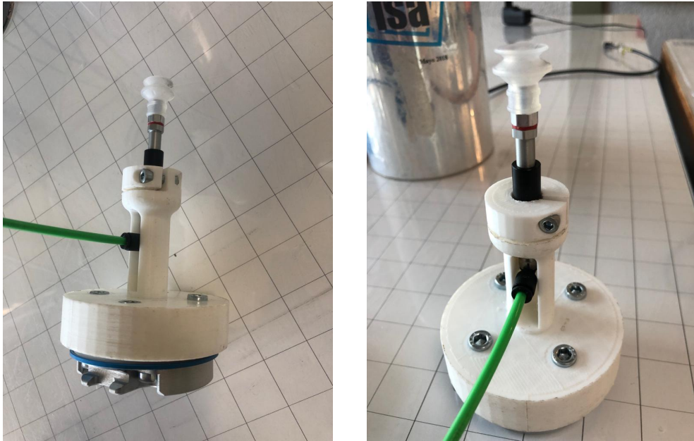
Figura 5.9: Herramienta del robot: Ventosa
