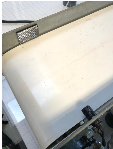
Figura 5.6: Montaje del sensor en la cinta transportadora
