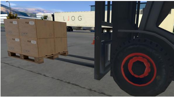
(a) levanta las horquillas del suelo ligeramente.
