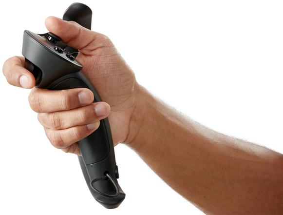
(a) palanca de pulgar derecho. VALVE INDEX
