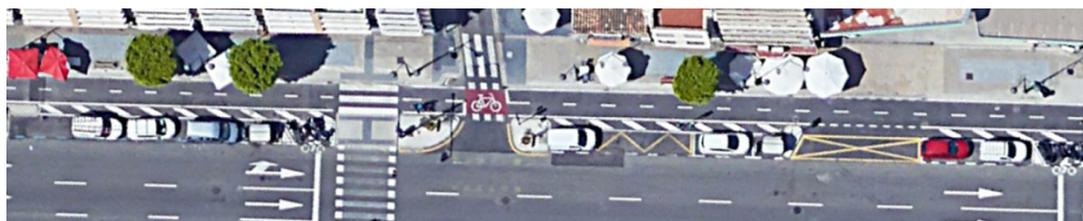
Imagen 31. Separación entre estacionamiento de vehículos y carril bici en Av. del Puerto
