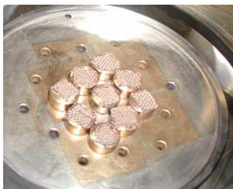
Para la observación y estudio de la morfología general de las microcápsulas, su situación sobre las fibras se utilizó un microscopio electrónico de transmisión JEOL JSM-6300 (Jeol USA Inc., Peabody, USA).
