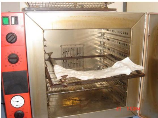
Figura 4.2.- Estufa de aire forzado para el termofijado de los tejidos con Microcápsulas
