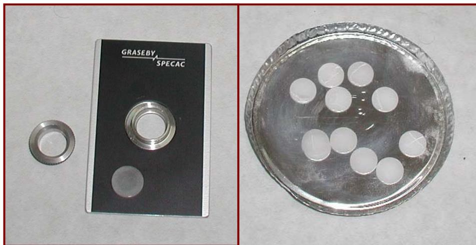
Figura 4.6.- Soporte para transmitancia y comprimidos con hilos procedentes de los tejidos ensayados.
