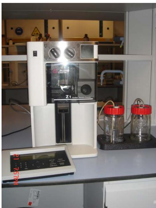
Figura nº 4.4.- Contador de partículas, Coulter Counter serie Z
