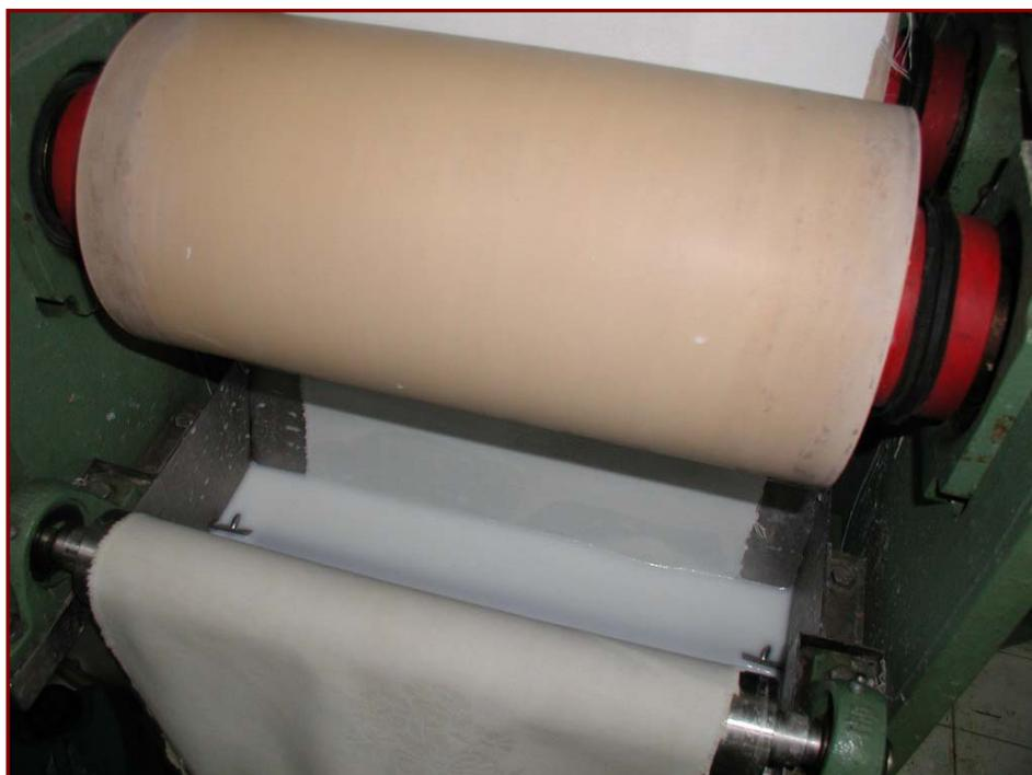
. Figura 4.1.- Fular, tejido y baño de aplicación de las microcápsulas
