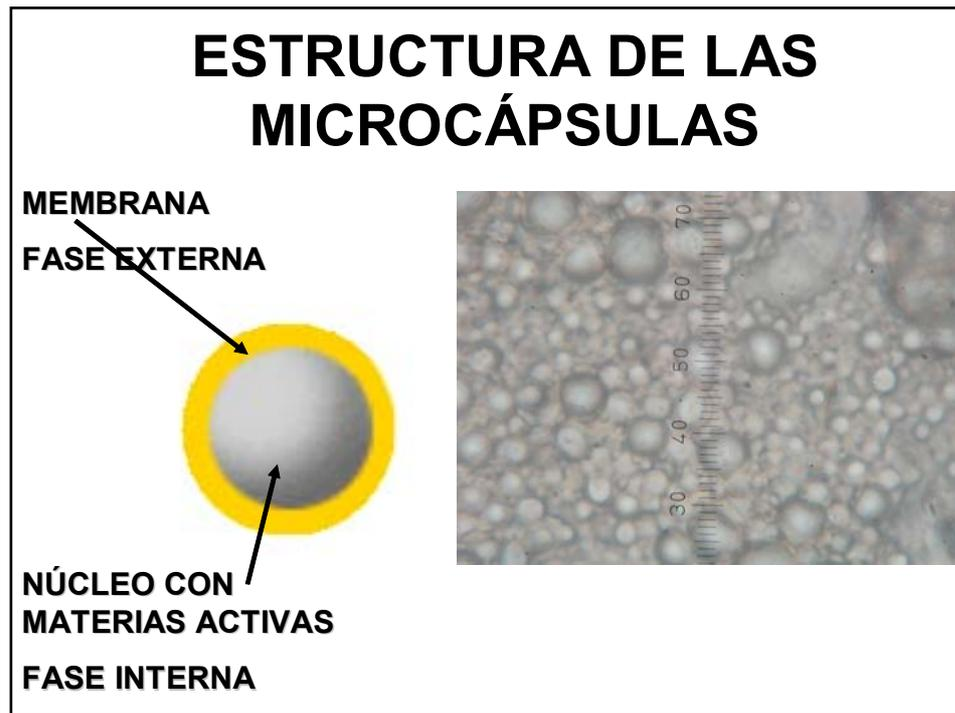
Figura 1.1. Estructura de las microcápsulas. Microfotografía de los laboratorios del DITEXPA de microcápsulas de emulsión
