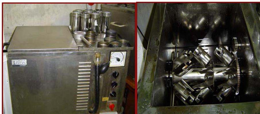
Figura 4.3. Linitest para ensayos de lavado de las microcápsulas
