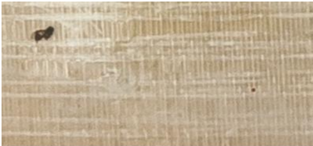
Imagen 259 - En este fragmento se puede observar el entramado pequeño de la fibra de vidrio.
