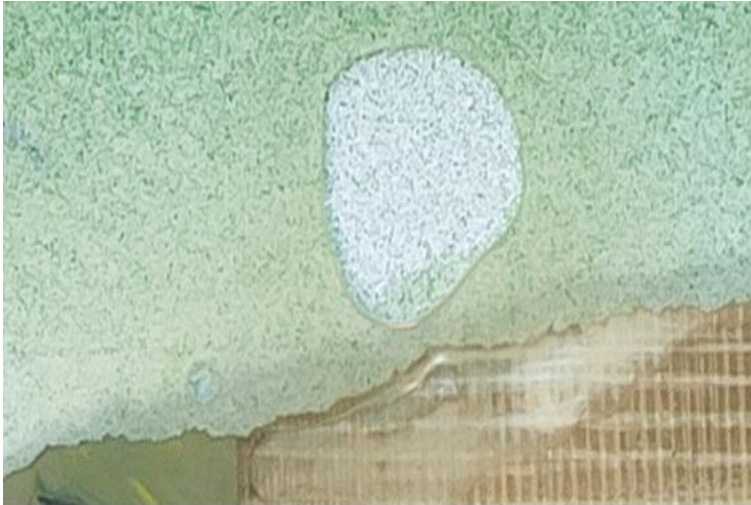
Imagen 256 - (Fragmento) – Otra burbuja por falta de resina. El papel impide una perfecta cubrición del molde.
