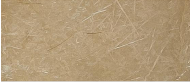
Imagen 258 - En este fragmento se puede observar el hilo fino de la fibra de vidrio.
