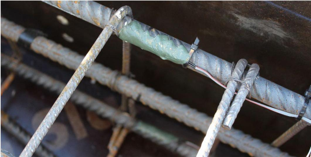
**Figura 2.** Galga extensométrica dispuesta en columnas antes del hormigonado.
