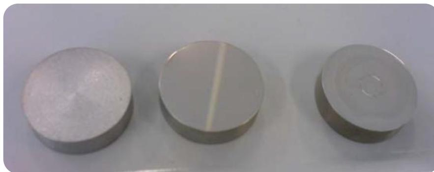
**Figura 12. Electrodo de trabajo antes del pulido (izquierda), después del pulido (centro), y después del ensayo tribológico (derecha)**
