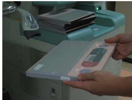
Chasis con pantallas fosforescentes fotoestimulables Fuji FCR 500MA
