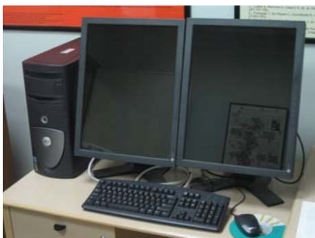
Pantallas de visualización EIZO mod. FC-2090 LCD monocromo 53 cm
